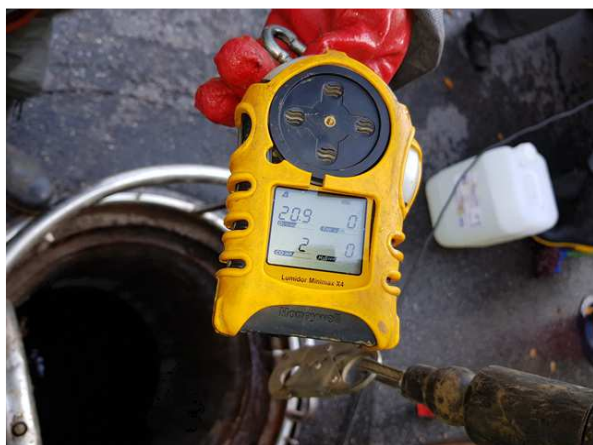
내용 출입전 산소 농도 측정
